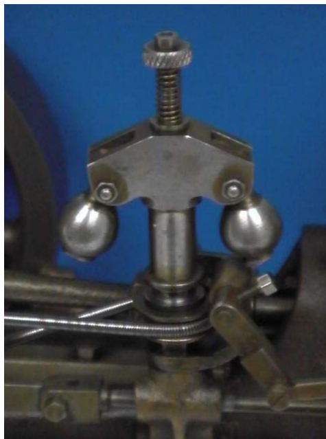
Figura 1. El gobernador centrífugo de velocidad simple.
